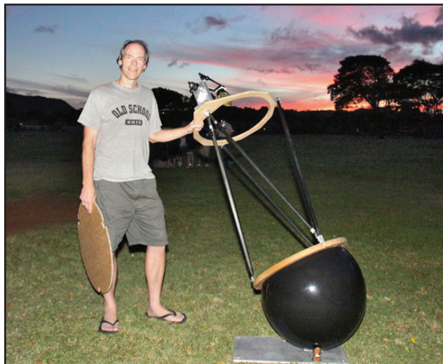
مایک لینولت (LMK) با تلسکوپ بازتابی نیوتونی دست ساز ۱۲۰ اینچی f/۳.۶ خود همراه با پایه ی گرد.
